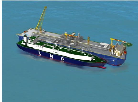
FSRU and LNG Carrier
